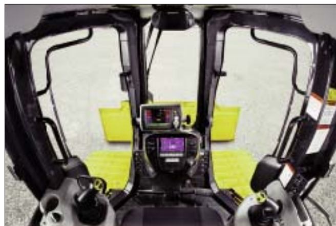
Brak masztów, umieszczony niżej wyświetlacz, a także „skośny nos” spycharek Komatsu zapewniają operatorowi doskonałą widoczność na cały obszar roboczy z przodu maszyny
