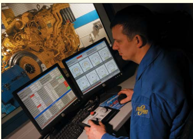
Wszystkie elementy wewnątrz regenerowanego podzespołu są wymieniane, sprawdzane i kalibrowane, a silniki przechodzą odpowiednie próby na hamowni. W procesie regeneracji firma Komatsu wykorzystuje tylko części oryginalne
