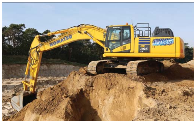
Dzięki zastosowaniu elektrycznego napędu w układzie obrotu „hybryda” Komatsu odznacza się krótszymi cyklami roboczymi, a tym samym większą wydajnością
